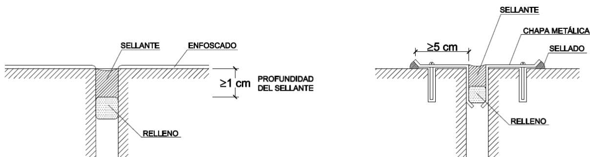
Figura 2.6 Ejemplos de juntas de dilatación
